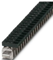
Bloc de jonction, tension nominale: 300 V, intensité nominale: 41 A, type de raccordement: Raccordement vissé, Section de référence: 4 mm<sup>2</sup>, section : 0,5 mm<sup>2</sup> - 6 mm<sup>2</sup>, montage: Barre collectrice de N, coloris: noir
