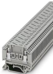
Paire de blocs de jonction pour tension thermoélectrique, TC type K, tension nominale: 400 V, intensité nominale: 1 A, nombre de connexions: 4, nombre de pôles: 2, type de raccordement: Raccordement vissé, 1er étage, section : 0,2 mm<sup>2</sup> - 4 mm<sup>2</sup>, type de montage: NS 35/7,5, NS 35/15, NS 32, coloris: gris
