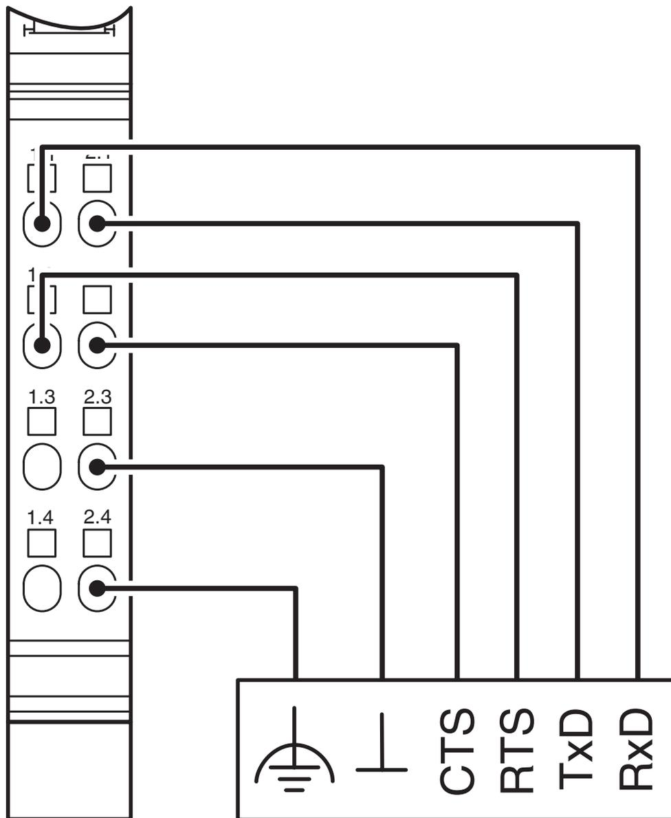
Câblage d'interface RS-232 : Handshake à quatre fils
