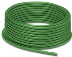
Au mètre, Câble interstation, INTERBUS, blindé, PUR exempt d'halogène, vert RAL 6017, 6 fils (3 x 2 x 0,22 mm<sup>2</sup>), coloris du fil: vert-jaune, blanc-marron, gris-rose, Pose flexible
