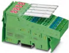
Inline, Module de sortie numérique, Sorties TOR: 16, 24 V DC, 500 mA, connectique: 3 fils, vitesse de transmission dans le bus local: 500 kBit/s, indice de protection: IP20, y compris connecteurs mâles Inline et champs de repérage
